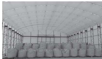
手賀沼終末処理場のテント倉庫に保管されている高濃度焼却灰
